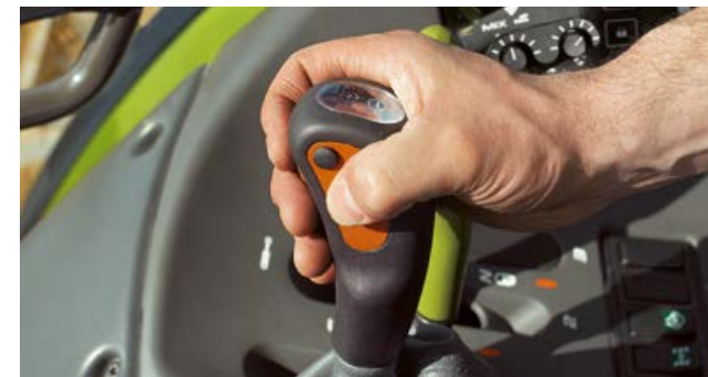
Чотири ступені перемикання під навантаженням у багатьох випадках звільняють вас від зміни груп передач.
