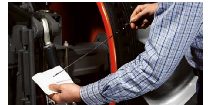
Контроль рівня трансмісійної оливи легко здійснюється на задній частині.
